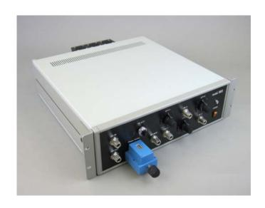
本製品は2.856GHzを入力源および基準信号とし、その1/36逓降出力を高精度増幅、分岐出力させる分周、バッファユニットです。
